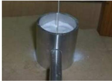
図 超音波振動管
